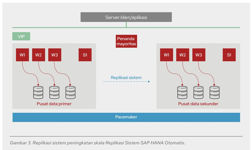
Gambar 3. Replikasi sistem peningkatan skala Replikasi Sistem SAP HANA Otomatis.
